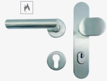
Sicura 45 (WK2) Sicherheitsdrücker (inkl. Kernziehschutz) auch für Feuerschutztüren geeignet. (außen Langschild/innen Rosette)
